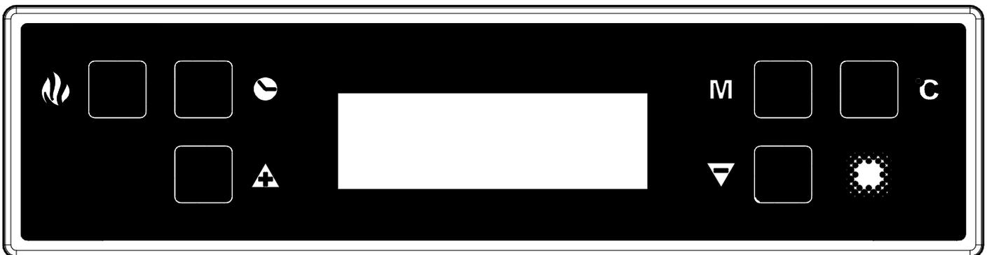
Il pannello comandi è gestito da microprocessore. Il sistema di rilevazione delle temperature è affidato a delle termocoppie. Il display di grandi dimensioni migliora la gestione dell'apparecchio rendendo immediate letture e funzioni disponibili. La caratteristica principale del pannello è quella di gestire in modo completamente automatico l'apparecchio. Di seguito vengono descritti i comandi e le varie visualizzazioni.
