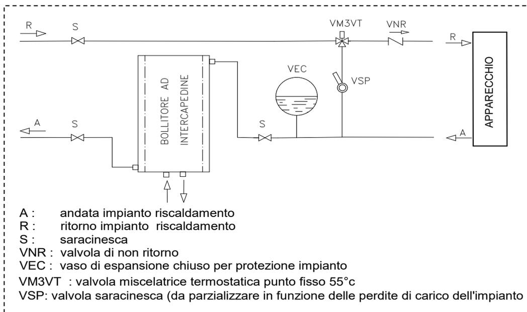
**ATTENZIONE:** La temperatura dell'acqua nel bollitore è, in questo caso, non regolabile e dipende dalla temperatura di mandata dell'impianto, ossia della temperatura impostata nel generatore. È possibile installare il bollitore sul circuito di ritorno. Allo scopo di mantenere in ottima efficienza il bollitore, si consiglia d'installare nell'impianto sanitario un addolcitore.
