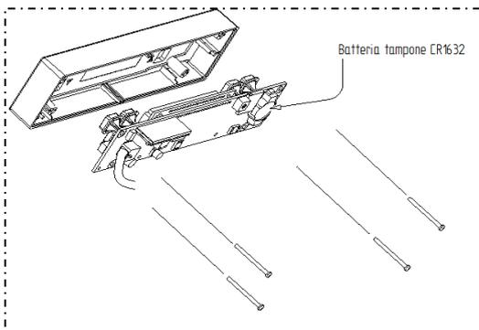
Quando l'ora e la programmazione non rimangono memorizzate (all'interno del pannello è presente una batteria tampone modello CR1632 esposta a normale usura) è necessario procedere alla sostituzione della stessa agendo sulle 4 viti poste posteriormente al pannello comandi. La batteria scarica, quando rimossa, deve essere eliminata in modo sicuro.
