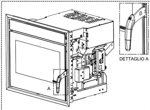
Il vostro apparecchio è fornito di una maniglia removibile per aprire e chiudere la porta focolare in modo da poter eseguire le operazioni di pulizia richieste (vedi paragrafo dedicato). Si raccomanda una volta terminate tali operazioni di rimuovere la maniglia in modo da evitare l'apertura accidentale della porta.
