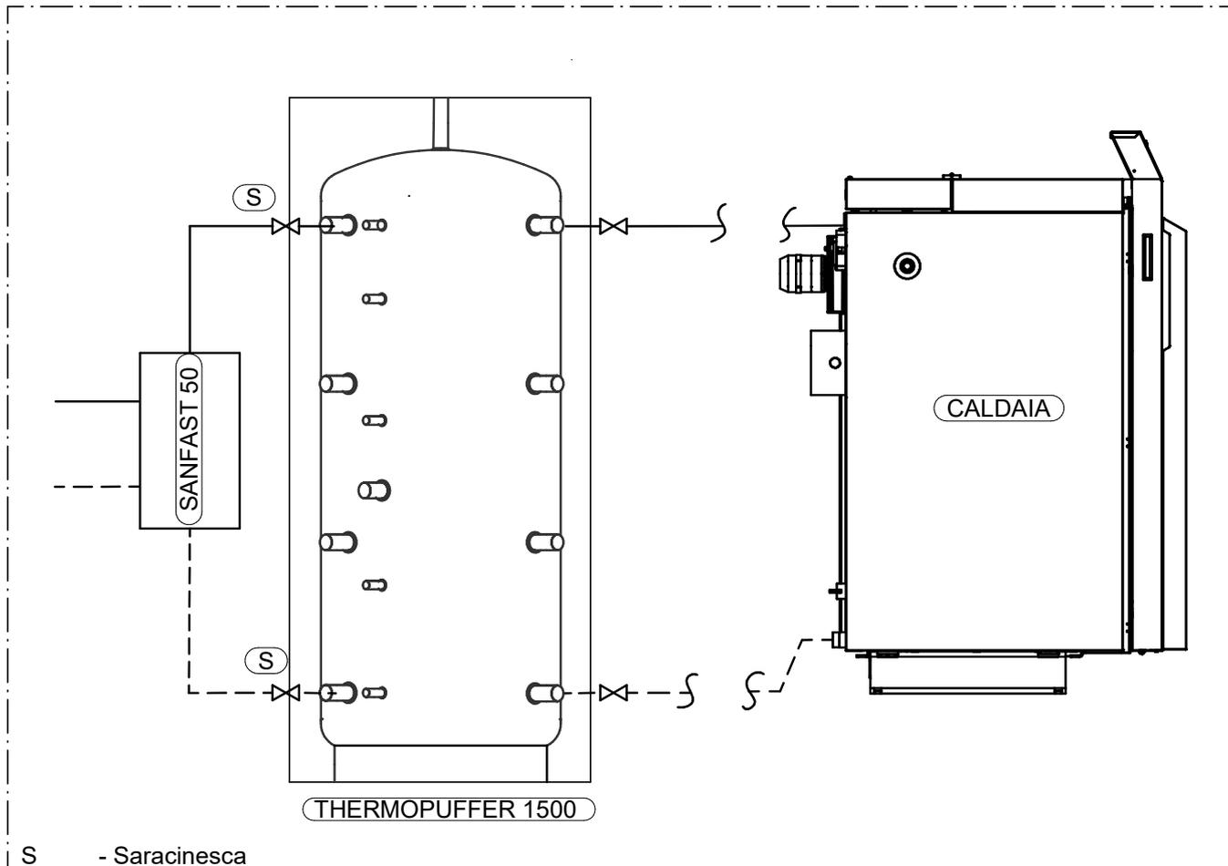
**ATTENZIONE:** Prima di caricare l'impianto è obbligatorio verificare che la pressione di precarica del vaso di espansione o dei vasi di espansione sia di 1,5 bar. Successivamente caricare l'impianto fino a portarlo ad una pressione di 1 bar.
