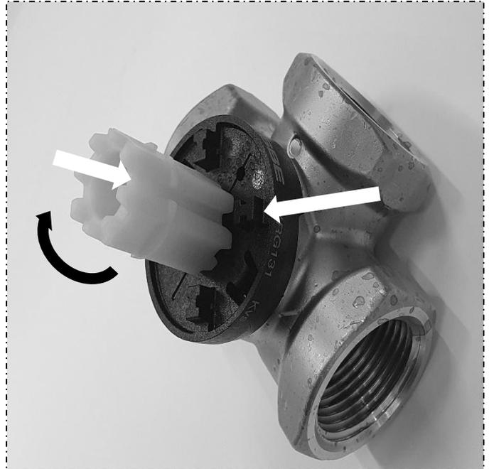
**2** – Ruotare il cursore fino a quando la scanalatura dello stesso raggiunge il dentino della valvola indicato nella foto sopra.
