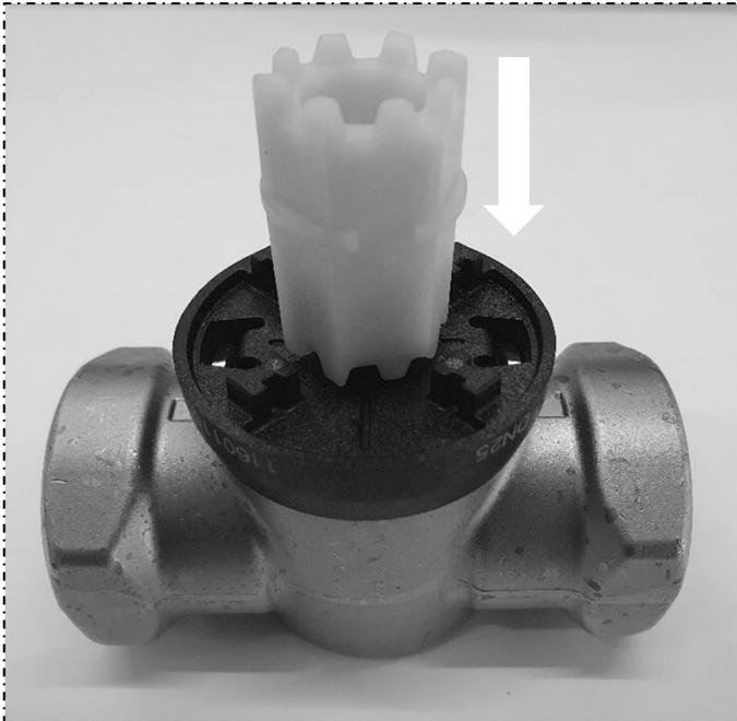
**1** – Inserire il cursore dentato nel corpo della valvola fino a fine corsa. Per farlo inserirlo dalla parte più lunga come raffigurato nella foto sopra.
