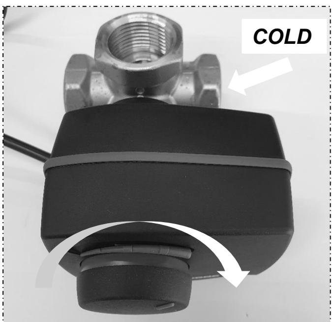
**8** – Per verificare se l'installazione è andata a buon fine ruotare il tappo estratto in senso orario fino a fine corsa. Se il ramo COLD risulta completamente chiuso l'installazione è andata a buon fine, altrimenti si consiglia di ricominciare dall'inizio la procedura. Premere infine il tappo verso l'interno fino a far scomparire la banda di colore rosso.
