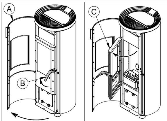
Per aprire e chiudere la porta del focolare (C) aprire la porta esterna (A) e utilizzando l'apposita maniglia (B), sbloccare il gancio di tenuta. Si raccomanda una volta terminata tale operazione di rimuovere la maniglia in modo da evitare l'apertura accidentale della porta. Aprire la porta solo per le operazioni di pulizia e tassativamente ad apparecchio freddo e sconsnesso elettricamente.
