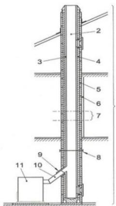
Chaque cheminée doit être composée au minimum des composants prévus par la norme UNI EN 1443, et indiqués dans la figure ci-contre.
