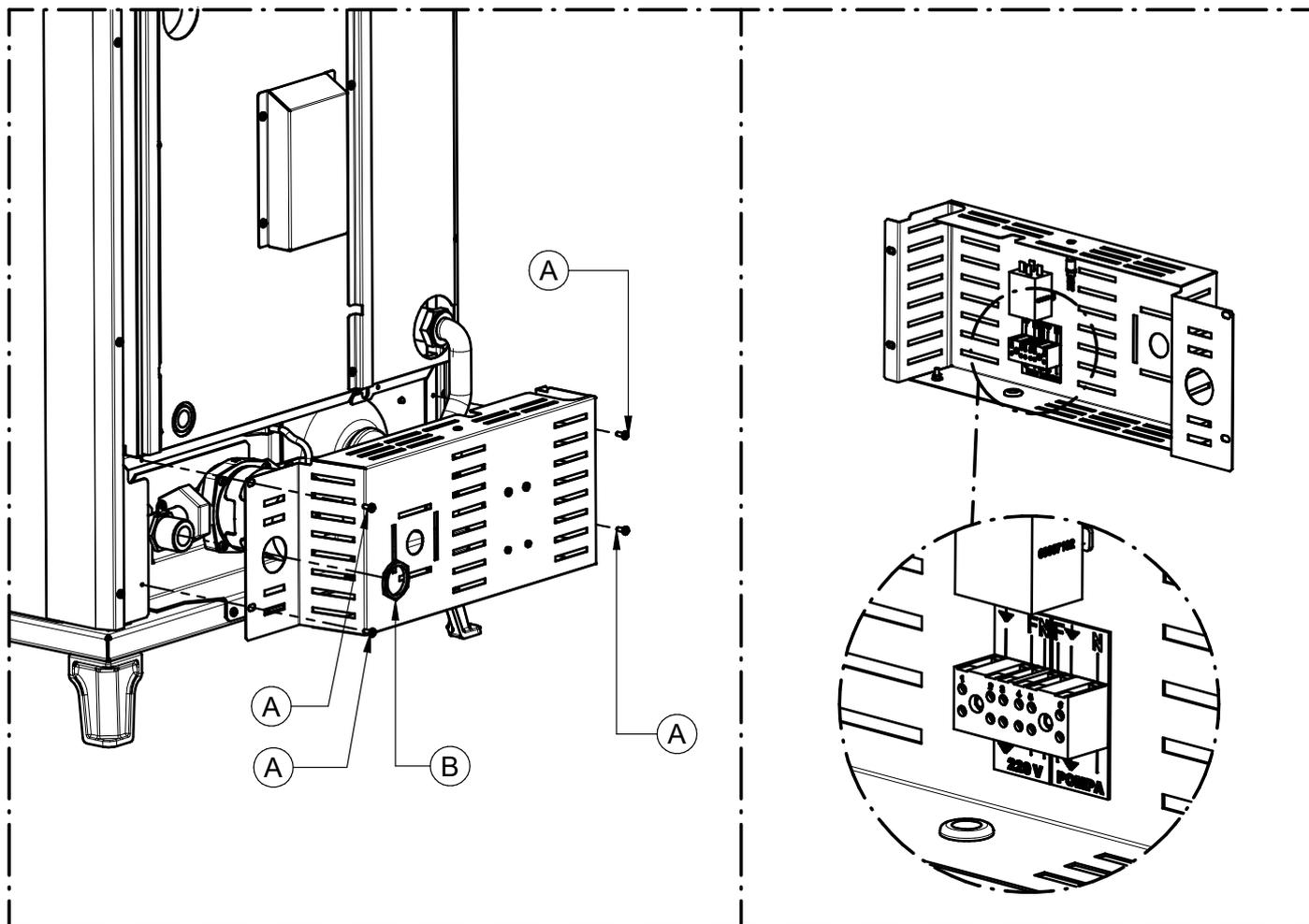
Le bornier de raccordement de l'alimentation électrique est situé à l'arrière. Pour l'atteindre, il faut retirer la plaque de protection en dévissant les vis (A) et l'écrou (B).
