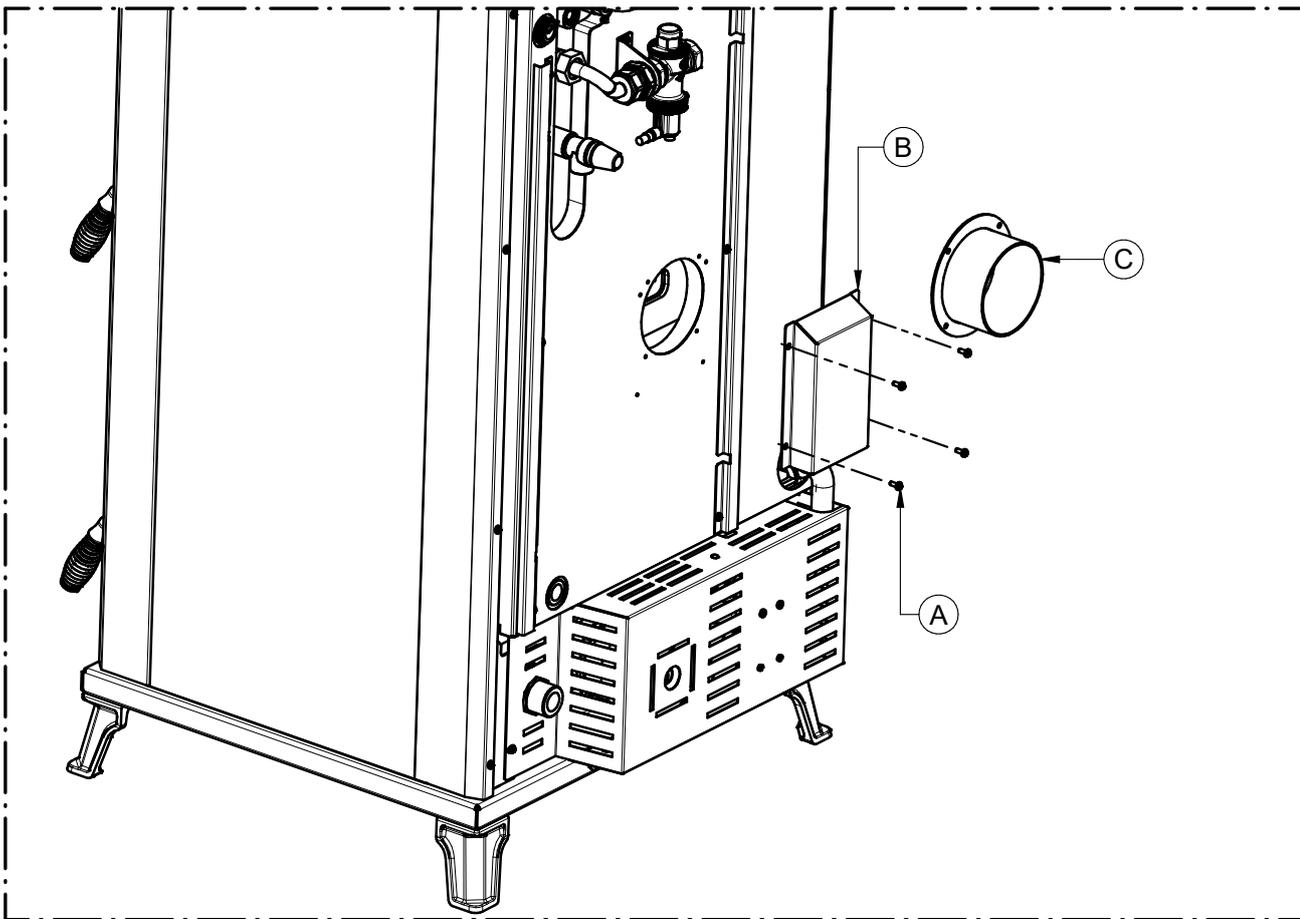
Pour installer le kit prise d'air de combustion de l'extérieur, il faut dévisser les vis (A) et retirer la plaque de protection (B). Installer le collier (C) avec les vis (A) précédemment enlevées. Raccorder la prise d'air de l'appareil à l'extérieur du bâtiment au moyen de conduits appropriés résistants aux hautes températures. La longueur du conduit ne doit pas dépasser 600 mm.
