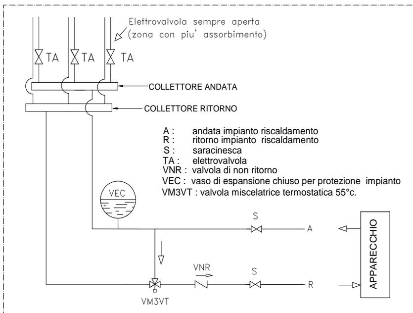
Observations : au-dessus de 61°C, la pompe du générateur est toujours active car la dissipation de la chaleur est essentielle ; par conséquent, l'électrovanne doit être ouverte pour les raisons suivantes :
