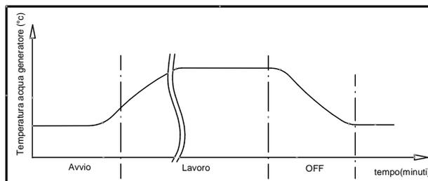
**WORK** : la durée dépend de la prédisposition du système à recevoir la chaleur. L'état de fonctionnement du générateur est indiqué sur l'afficheur. Pendant cette phase, le mécanisme de nettoyage du brasero « Pellet Power », c'est-à-dire l'ailette située à l'intérieur du brasero, se déplace de manière temporisée.
