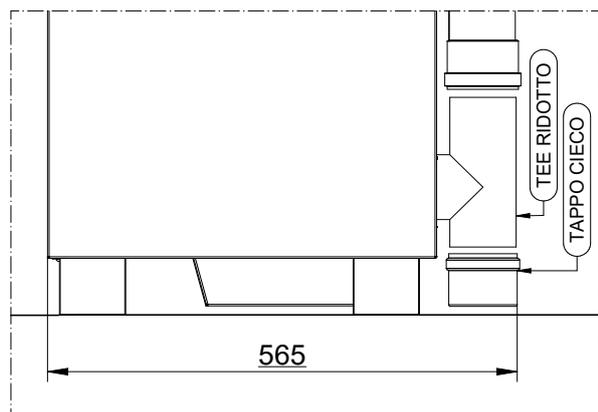
Im Lieferzustand des Gerätes ist das Bedienfeld mit dem Wärmeerzeuger zusammengefügt: Der Anschluss an den Rauchabzug muss in diesem Fall vorgenommen werden, wie in Abbildung 1 gezeigt. Besonders zu achten ist auf den Zusammenbau des Rauchabzugsrohres, weil dieses mindestens 24 mm vom Bedienfeld entfernt sein muss (Abbildung 1): Der Anbau des Rohres in der Nähe der Bedientafel führt zu deren Beschädigung (dieser Schaden ist nicht von der Gewährleistung gedeckt).
