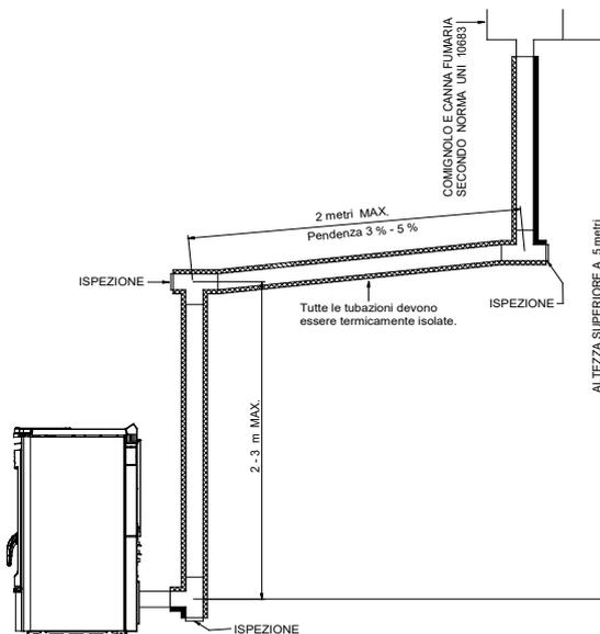
Bei einem klassischen gemauerten Abzug sind ein T-Stück mit Inspektionsverschluss und sachgerechte Tragbügel erforderlich. Bei überdimensioniertem Rauchabzug ist vorgeschrieben, zur Abhilfe ein porzellan-emailliertes oder nicht rostendes Stahlrohr einzuziehen.
