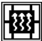
Angezeigt wird das Ausschalten der Belüftung. Das Raumluftgebläse ist also deaktiviert. Sollte die Temperatur des Ofenkörpers jedoch ansteigen, wird das Gebläse eingeschaltet. Die Gebläseleistung wird mit steigender Temperatur erhöht, was an den aufleuchtenden Balken rund um das Symbol erkennbar ist. Ist die Temperatur unter eine bestimmte Schwelle abgesunken, schaltet sich das Raumluftgebläse automatisch ab.
