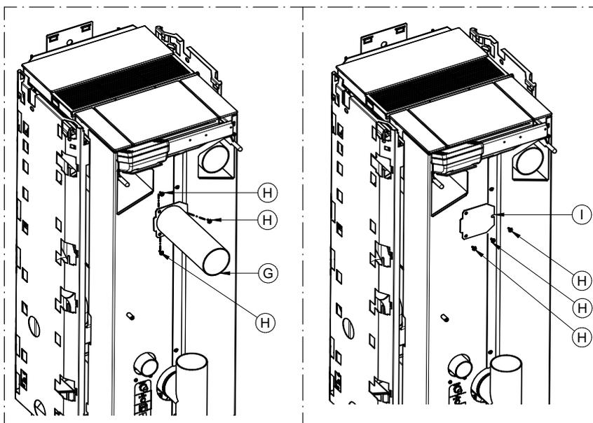
Werden unterschiedlich lange Rohrleitungen verwendet, wird geraten, teilweise verschließbare Regler für die Einstellung des Luftdurchsatzes einzusetzen. Andernfalls kann es sein, dass die kürzere Kanalisierung zulasten der längeren Kanalisierung sehr viel mehr Luft erhält.
