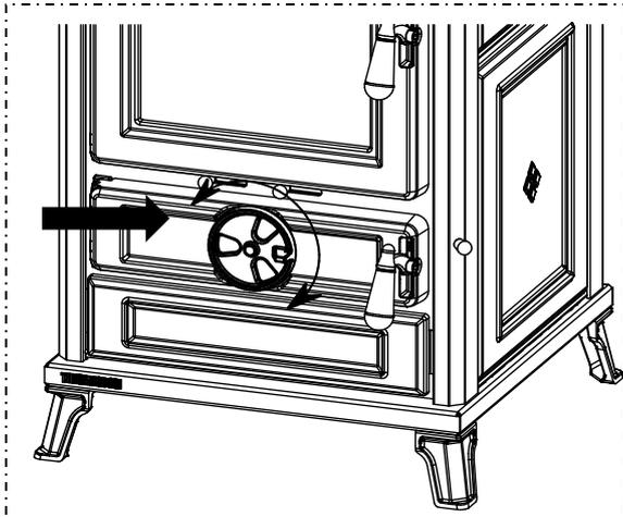
Regula el flujo de aire primario. El aire primario que pasa por la rejilla del hogar alimenta la combustión, y determina así su potencia y velocidad. Al girar el regulador en sentido contrario a las agujas del reloj se reduce el suministro de aire. Por el contrario, al girar el regulador en el sentido de las agujas del reloj, se aumenta el suministro de aire.
