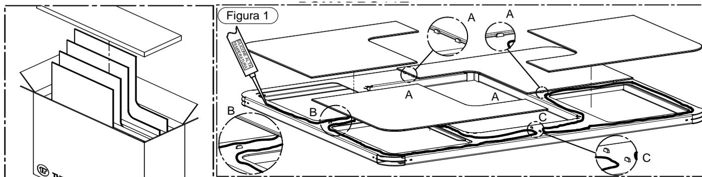
Para encolar los vidrios en el panel frontal, aplicar silicona sobre la superficie del frontal, tal como se muestra en la figura 1. Atención: tal como se evidencia en el detalle C, no aplicar silicona sobre las zonas de cruce de las aristas de los vidrios. En caso contrario, la silicona podría desbordarse, comprometiendo la estética del producto.
