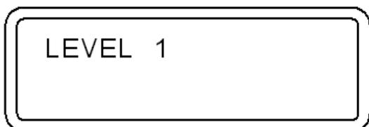
2) Para modificar el nivel de funcionamiento, mantenga pulsado un **Botón de Desplazamiento** y, simultáneamente, pulse el otro **Botón de Desplazamiento**.
