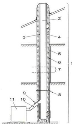
Cada chimenea debe estar compuesta al menos por los componentes previstos por la norma UNI EN 1443, indicados también en la figura de la izquierda.
