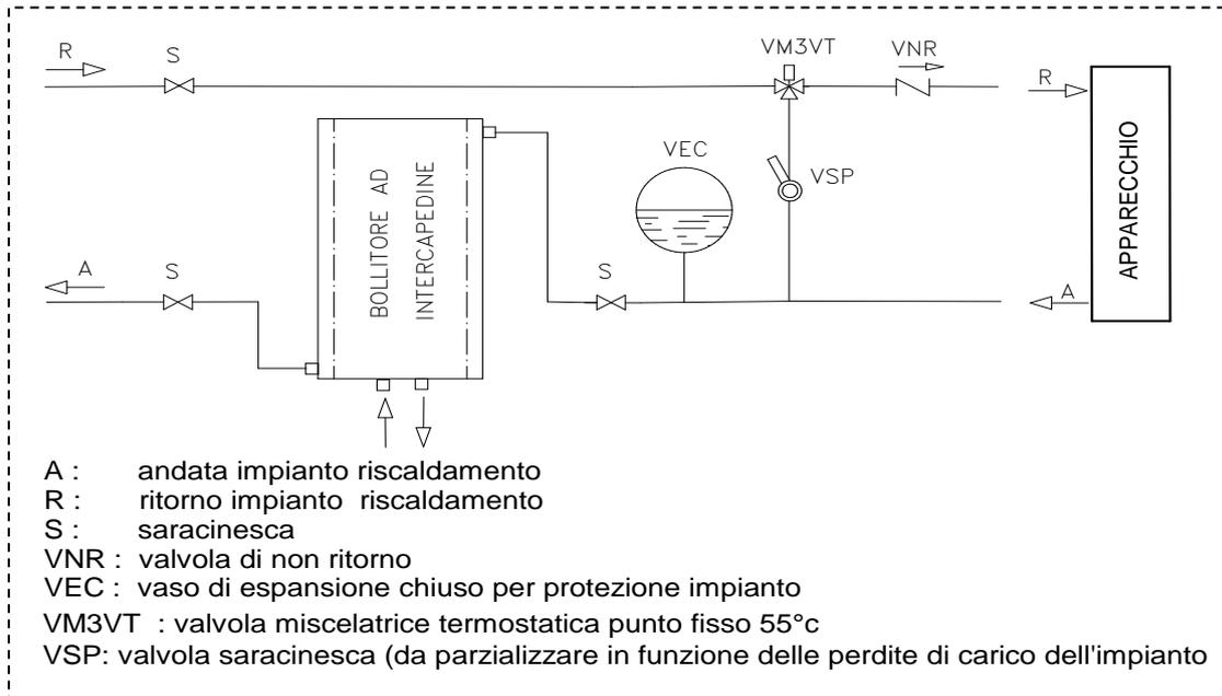
**ATTENZIONE:** La temperatura dell'acqua nel bollitore non è in questo caso regolabile e dipende dalla temperatura di mandata dell'impianto, ossia della temperatura impostata nel generatore. E' possibile installare il bollitore sul circuito di ritorno. Allo scopo di mantenere in ottima efficienza il bollitore, si consiglia d'installare nell'impianto sanitario un addolcitore.
