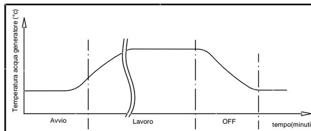
**WORK:** la durata dipende dalla predisposizione dell'impianto a ricevere calore. Lo stato di funzionamento del generatore è indicato sul display. Durante tale fase il meccanismo di pulizia del braciere "Pellet Power", cioè la paletta all'interno del braciere, si muove in modo temporizzato.
