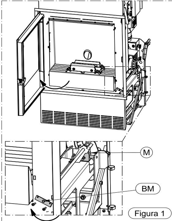
1) Aprire la porta del generatore utilizzando l'apposita maniglia, svitare le due viti del blocco (BM) e ruotare di 90 gradi in senso orario il blocco (BM).
