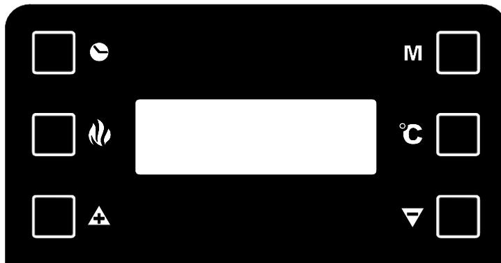
Il pannello comandi è gestito da microprocessore. Il sistema di rilevazione delle temperature è affidato a delle termocoppie. Il display migliora la gestione dell'apparecchio rendendo immediate letture e funzioni disponibili. La caratteristica principale del pannello è quella di gestire in modo completamente automatico l'apparecchio. Di seguito vengono descritti i comandi e le varie visualizzazioni.
