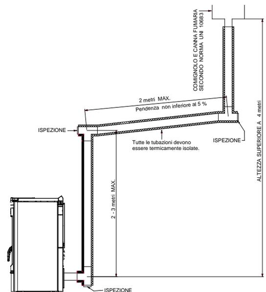
Quanto descritto sopra risulta indispensabile per poter rimuovere cenere ed incombusti che si possono depositare lungo il percorso di scarico. L'apparecchio funziona con la camera di combustione in depressione, mentre lo scarico dei fumi al camino ha una leggera pressione, di conseguenza è indispensabile assicurarsi che il sistema di scarico sia a tenuta ermetica.
