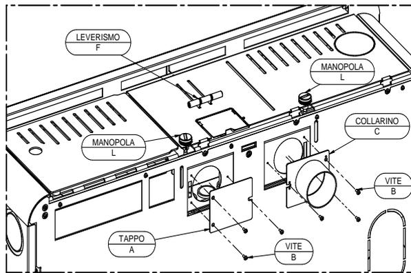
E' possibile distribuire l'aria calda anteriormente, lateralmente e posteriormente.
