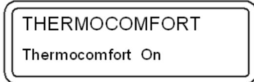
**ATTENZIONE:** Sarà possibile attivare la funzione THERMOCOMFORT e quindi selezionare ON nella schermata precedente, solo se l'apparecchio rileva il segnale del palmare. Si raccomanda quindi di assicurarsi che il palmare sia acceso e si trovi vicino all'apparecchio.
