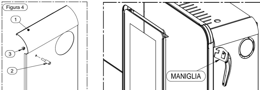
Per montare il gancio, smontare il fianco destro 1 della stufa (vedi paragrafo 4.3), posizionare nel foro il gancio 2 e bloccarlo con il dado 3. Riposizionare il fianco 1 sulla stufa.
