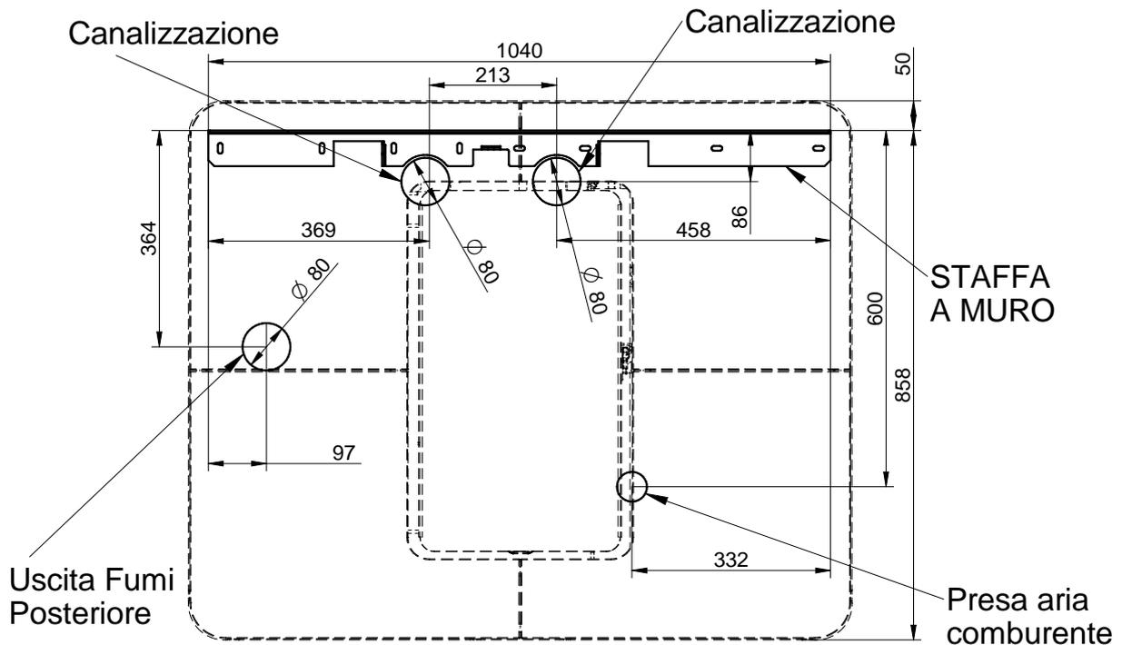
Appendere l'apparecchio alla staffa a muro A; una volta appeso l'apparecchio, appoggiarlo con forza a ridosso della parete e provvedere a riavvitare le viti di blocco B. In questa fase, prestare attenzione a fare coincidere i ganci di supporto (Vedi dettagli C e D della Figura 7).
