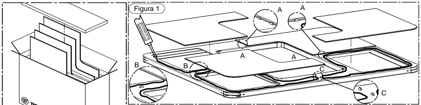
Per incollare i vetri sul pannello frontale, siliconare la superficie del frontale stesso mostrato in Figura 1. Attenzione: come evidenziato nel dettaglio C, non siliconare le zone d'incrocio degli spigoli dei vetri. In caso contrario, il silicone potrebbe sbordare compromettendo l'estetica del prodotto.
