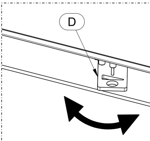
Regola l'afflusso dell'aria primaria. L'aria primaria passando attraverso la griglia del focolare alimenta la combustione determinando così la potenza e la velocità della stessa. Spostando la leva verso sinistra, si aumenta l'afflusso dell'aria. Al contrario spostando il regolatore verso destra si diminuisce l'afflusso dell'aria.
