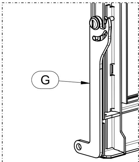
Permette l'apertura della porta per le operazioni di ricarica del combustibile. La ricarica della legna deve essere eseguita solamente quando la carica precedente si è esaurita o ridotta a semplici braci, successivamente aprire lentamente la porta di carico del focolare e riporre i ciocchi di legna in modo ordinato sopra il letto di braci. Concludere l'operazione chiudendo la porta sempre lentamente.
