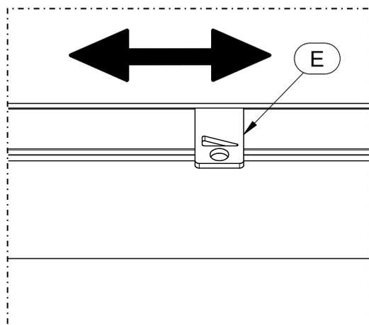
Regola l'afflusso dell'aria secondaria che, scorrendo sul vetro, ha la funzione di mantenerlo pulito. Spostando la leva verso sinistra, si aumenta l'afflusso dell'aria. Al contrario spostandola verso destra si diminuisce l'afflusso dell'aria.
