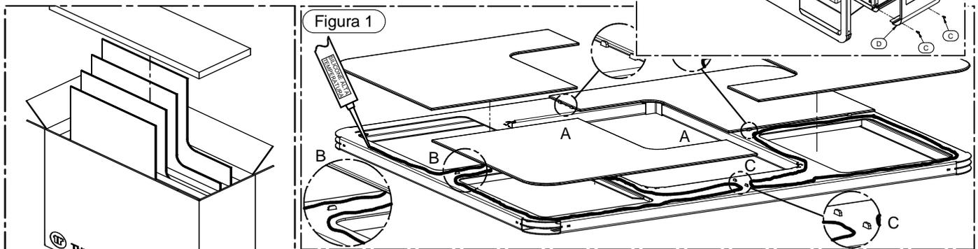
Pour coller les vitres sur le panneau avant, siliconer la surface du panneau avant comme le montre la Figure 1. Attention : comme le montre le Détail C, ne pas siliconer les zones d'intersection des bords des vitres. Sinon, le silicone pourrait déborder et compromettre l'esthétique du produit.
