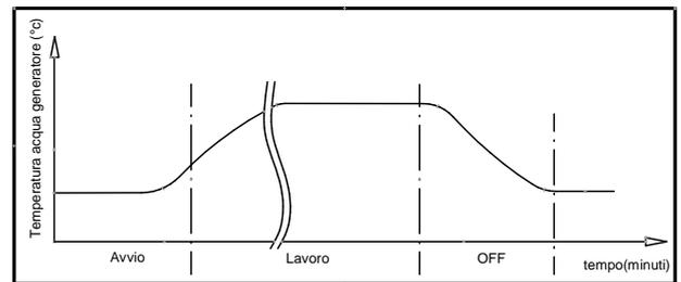
**WORK** : la durée dépend de la prédisposition du système à recevoir la chaleur. L'état de fonctionnement du générateur est indiqué sur la afficheur. Pendant cette phase, le mécanisme de nettoyage du brasero « Pellet Power », c'est-à-dire l'ailette située à l'intérieur du brasero, se déplace de manière temporisée.
